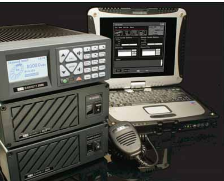
L'émetteur-récepteur Barrett 2050 HF est livré avec un modem 2023, une alimentation 2022 et un ordinateur bloc-notes équipé du logiciel Barrett 2020 de données, email et fax
